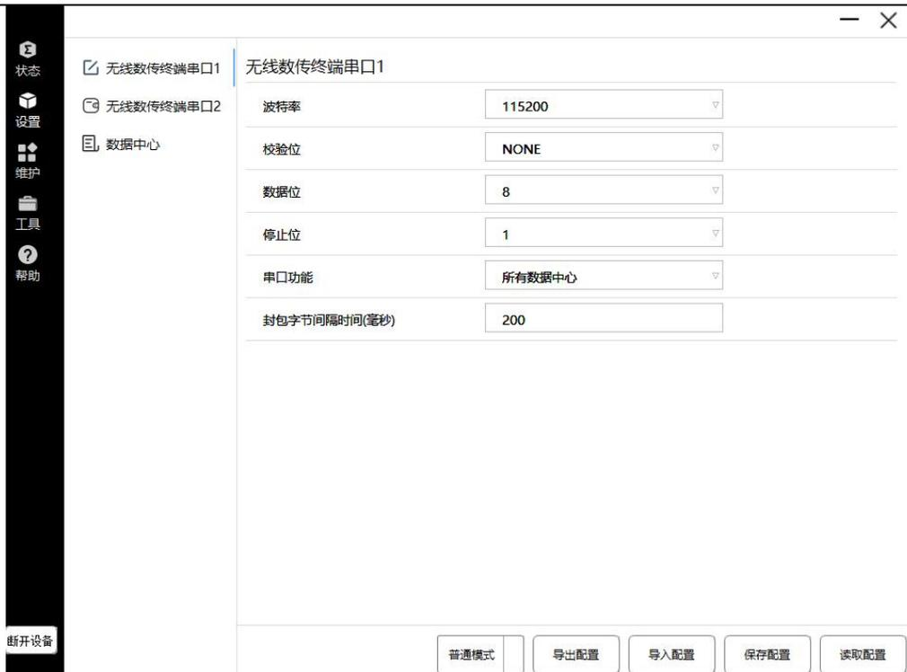
图 1.4 串口参数配置
