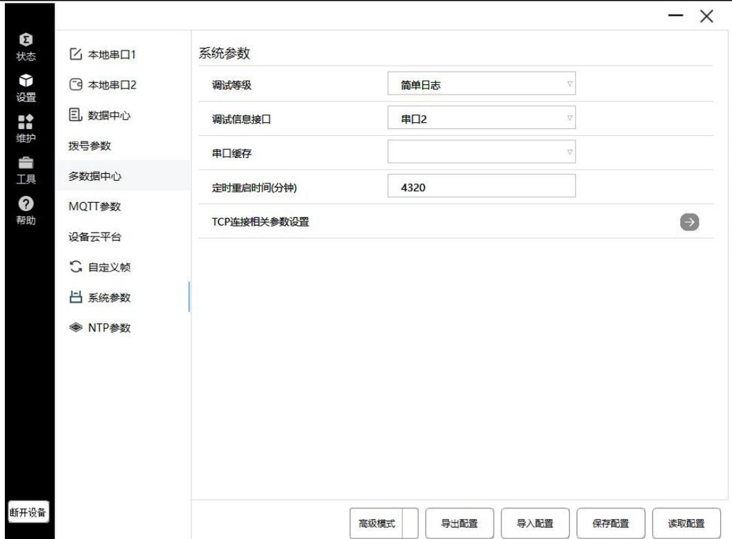
注：本地串口 1 默认为工作串口，本地串口 2 默认为调试串口。作用是当本地串口 1 处于连接下位机设备，我们可以通过串口 2 进入 DTU 的配置状态，修改 DTU 的配置。达到不影响 DTU 本地串口 1 和下位机接线。（配置完后保存需重启 DTU 上线）
