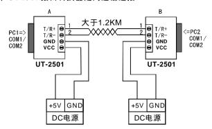
注:CAN 通讯线可以使用双绞线、屏蔽双绞线。若通讯距离超过1.2KM时,应保证线的截面积大于1.0mm。具体规格,应根据距离而定,常规是随距离的加长而适当加大。
