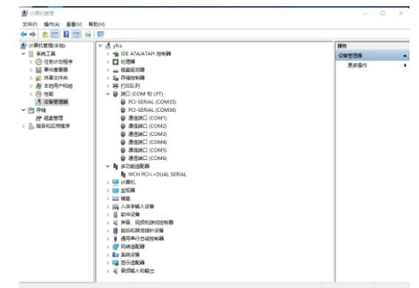
如果之前没有虚拟过串口，则系统默认COM口为COM3、4、5、6，按实际端口号为准，这样UT-7704驱动安装完毕。
