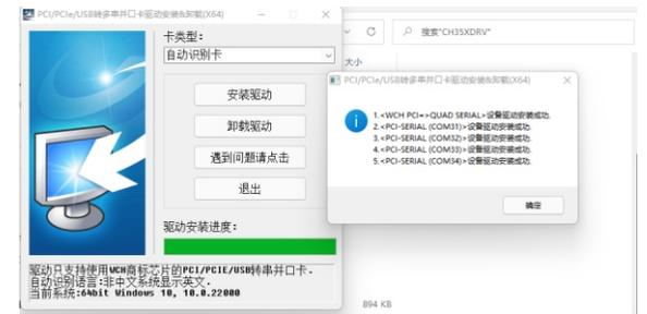
方法三：进入设备管理器找到多串口设备器右键更新设备驱动程序，找到本地驱动保存位置，按照电脑版本对应安装，安装后进入端口选项查看。
