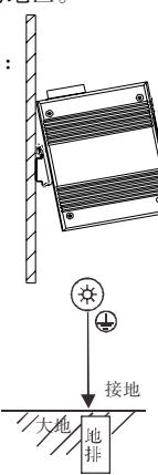
第一步：检查导轨的接地与稳定性；将交换机的导轨卡槽卡进导轨上；
