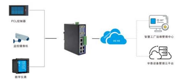
G9809 系列 4G 工业网关,可实现工业生产现场的 PLC、HMI、工业高清摄像头与网关连接,通过网关进行数据采集、数据预处理、数据分析。并通过 MQTT、HTTP 协议并上报到云端系统。云平台可实现设备远程状态监控,故障诊断分析、实时告警,实现可视化、帮助中小企业实现一套工业智能远程运维管理系统解决方案。
