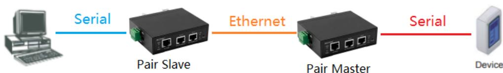
远程对从模式与远程对主模式一起使用需要两台串口服务器设备一起工作，用于突破串口的数据传输距离限制。该模式下的两台串口服务器通过以太网与对方建立网络连接，并透明的向对方传送来自各自串口的数据。
