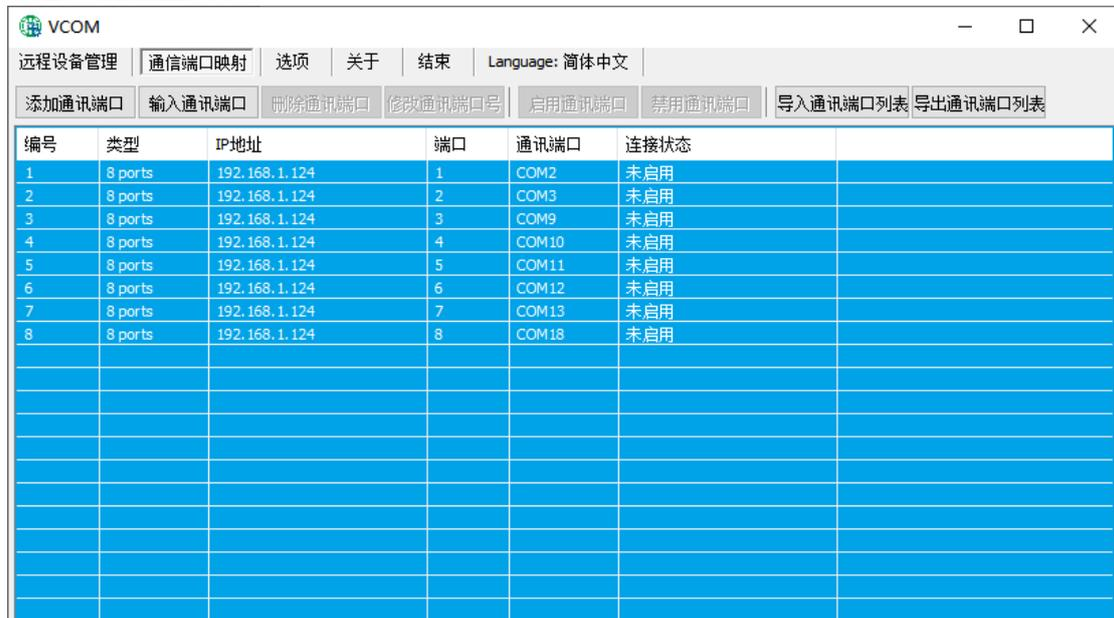
2、使用串口调试助手，分别打开虚拟串口和实串口，即可进行通信。
